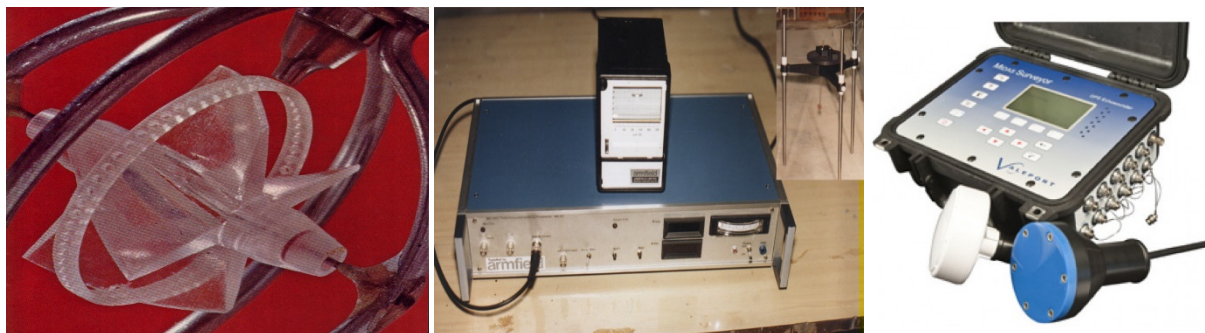
Дел од опремата во хидрауличката лабораторија: микро хидрометриско крило, осцилограф и ехосондер
