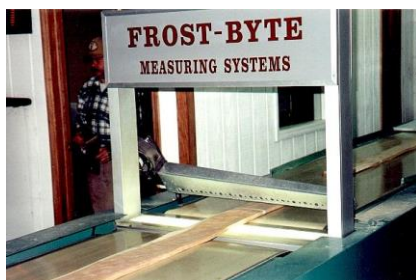
Слика 61. Мерен уред во линијата за завршна обработка на сечен фурнир
