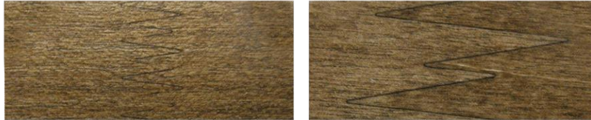
Слика 194. Продолжени надворешни фурнири со испреплетен групен чеп [34]
