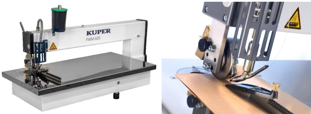
Слика 179. Машина за надолжно спојување на фурнирите со термопластичен конец (Kuper) [61]
