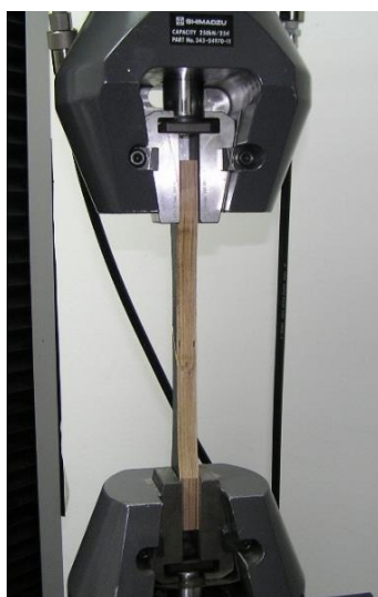
Слика 232. Испитување на јакоста на затегнување на фурнирски плочи [137]
