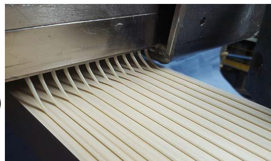
Слика 203. Нанесување на лепило со екструзија [139, 98]
