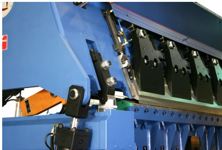
Слика 44. Супорт на нож и притисна греда кај вертикален фурнирски нож „Cremona“ [51]
