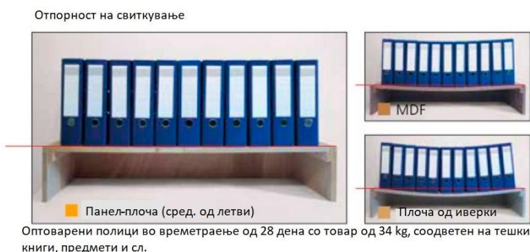
Слика 286. Отпорност на свиткување на полици изработени од различни типови на плочи [120]
