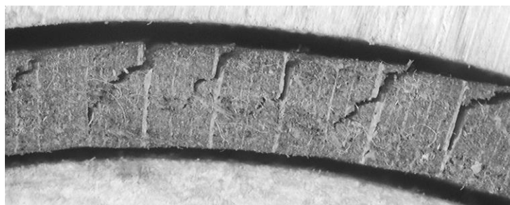
Слика 113. Пукнатини на буков фурнир со дебелина од 3 mm [111]
