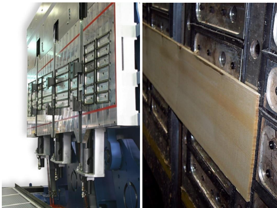
Слика 45. Работна маса со стеги за прицврстување на фличот кај вертикален фурнирски нож „Cremona“ [51]
