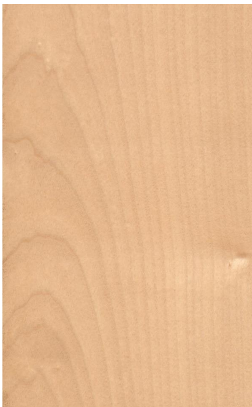
Сечен фурнир од бел јасен ( Fraxinus excelsior ) – полурадијален пресек
