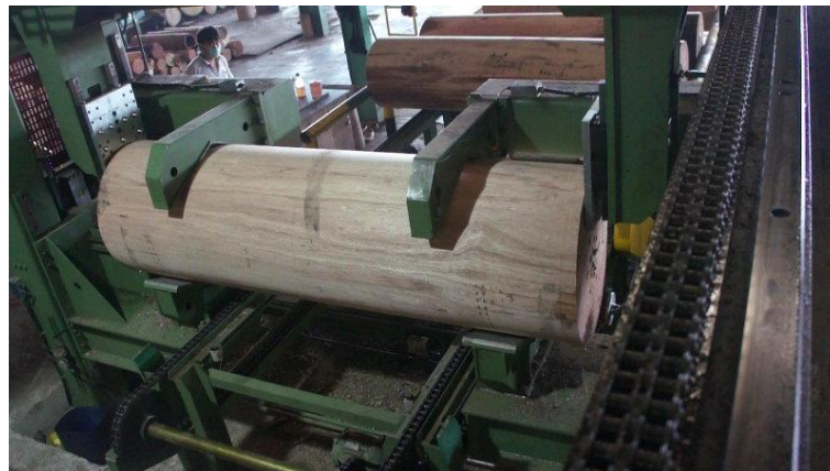
Слика 76. Геометриско центрирање со четири потпорни точки [53]
