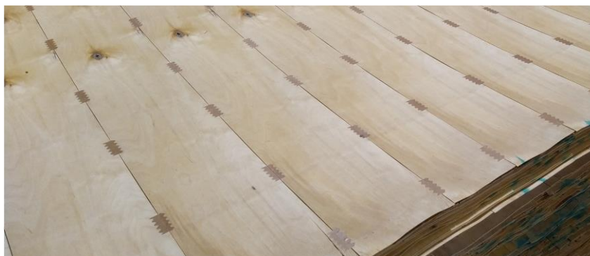
Слика 135. Состави од мокри фурнирски листови изработени на опрема од компанијата Raute [30]
