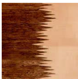
Слика 193. Продолжување на надворешни фурнири со испреплетен спој [61]
