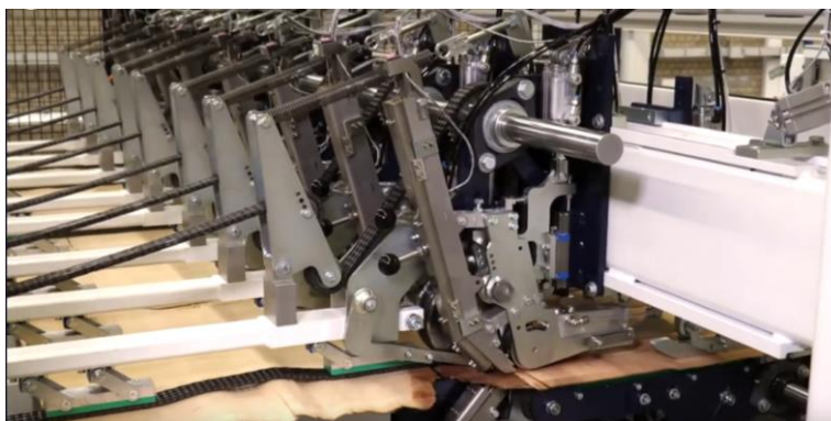
Слика 183. Напречен спојувач со термопластичен конец „Kiper“ [61]
