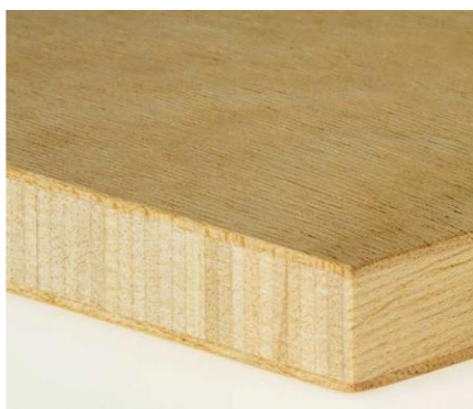
Слика 281. Пенел-плоча со средница од слепени блокови од фурнири [58]
