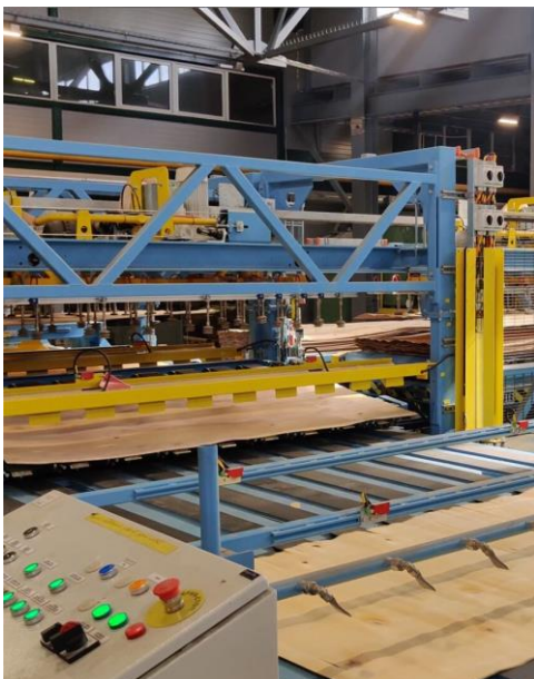
Слика 207. Автоматска линија за формирање на композиција на фурнирска плоча од фирмата „Raute“ со екструзионо нанесување на лепило [30]
