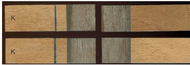
Слика 237. Изглед на смолкнати површини по испитување на јакоста на смолкнување [137]
