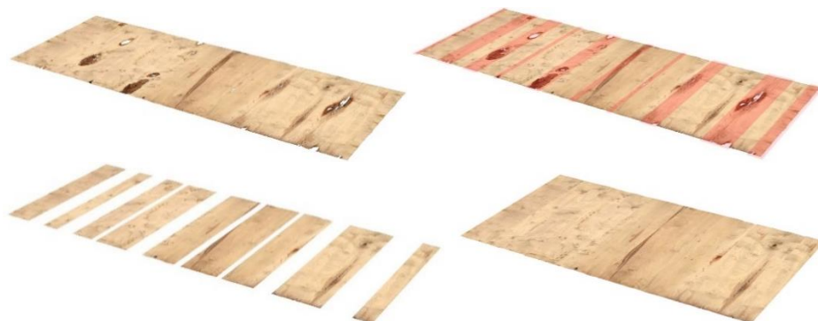
Слика 173. Автоматска детекција на грешки, отстранување на грешки и составување на формат на фурнирски лист [30]
