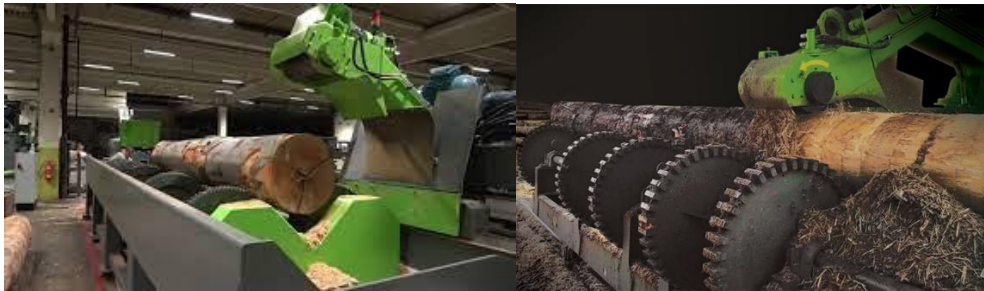
Слика 15. Линија за окорување со подвижен супорт [63]
