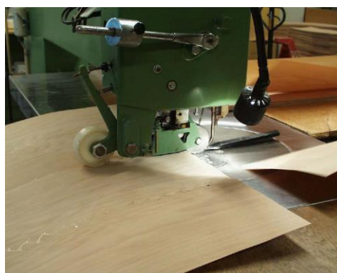
Слика 181. Надолжно спојување на фурнирите со термопластичен конец [99]
