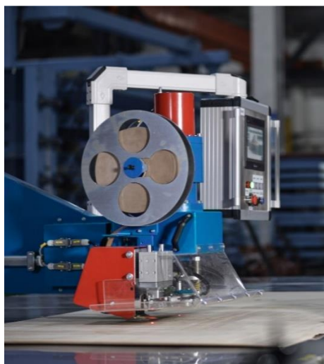
Слика 166. Машина за крпење на фурнири „Raute“ [30]
