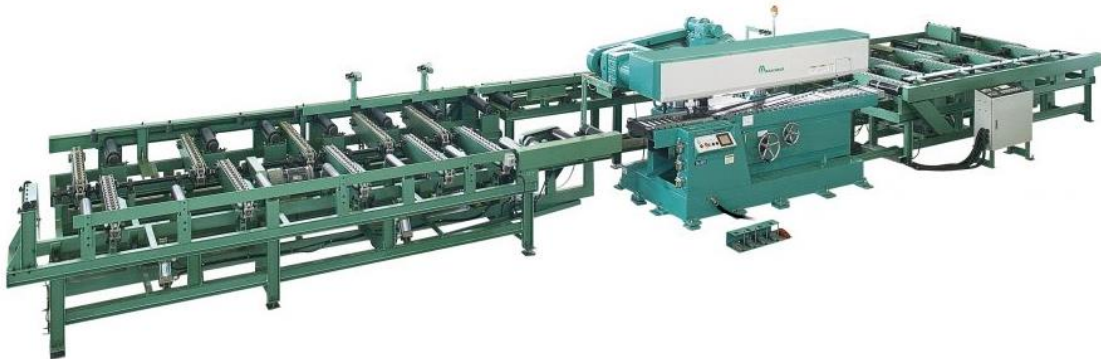
Слика 39. Линија за надолжно сечење на фурнири со систем на повратни транспортери („Merry-Go-Round“ систем) [41, 47]
