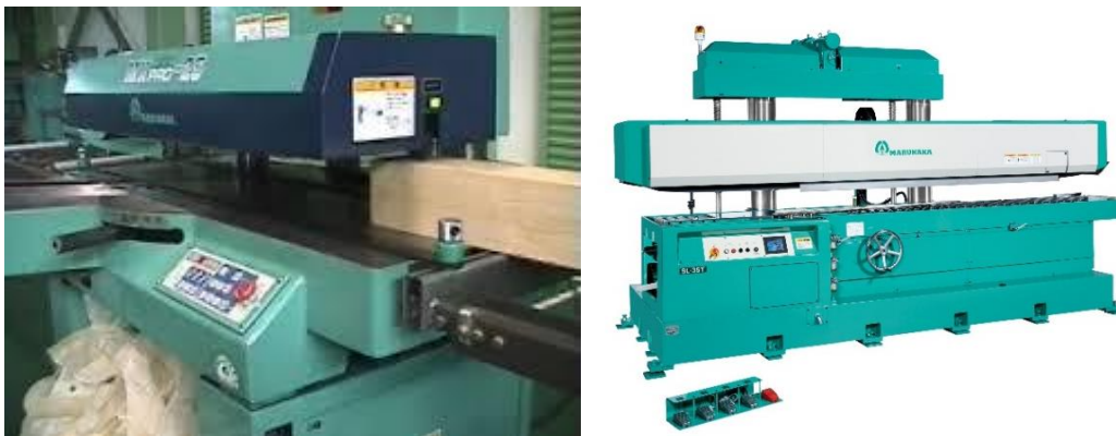
Слика 37. Јапонски нож со сечење по должина на влакната [41]
