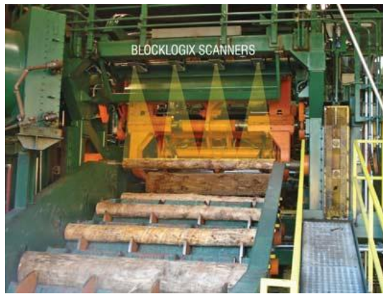
Слика 82. Електронско центрирање на трупци [75]
