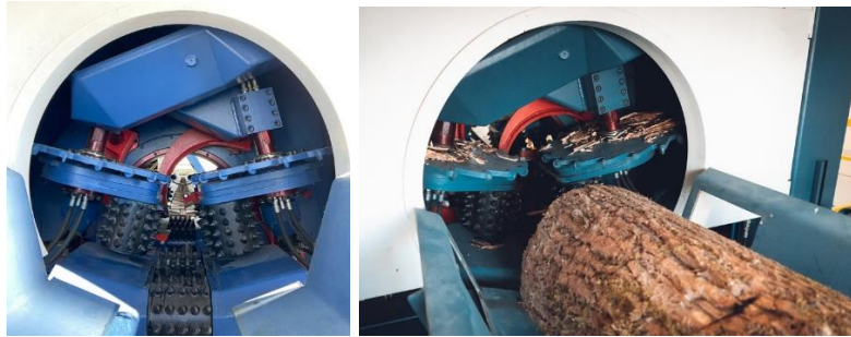
Слика 13. Уред за машинско окорување на трупец со нож како алат за окорување [51]
