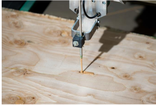
Слика 219. Поправка на плочи со китирање „Raute“ [30]
