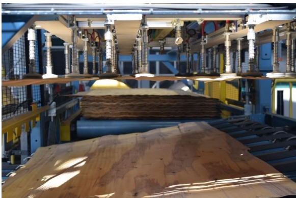
Слика 208. Делови од автоматска линија за формирање на композиција на фурнирска плоча од фирмата Raute со екструзионо нанесување на лепило [30]
