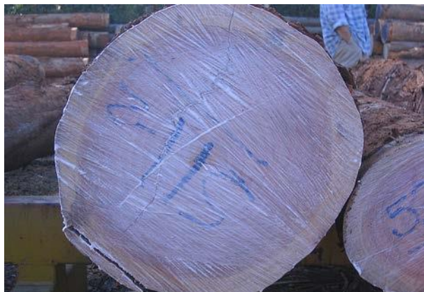
Слика 7. Премачкување на челата на трупците со восочна емулзија [98]
