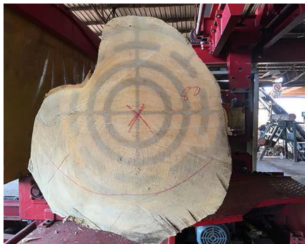
Слика 71. Проектирани светлосни прстени на челото на трупецот при оптичко центрирање на трупци [98]
