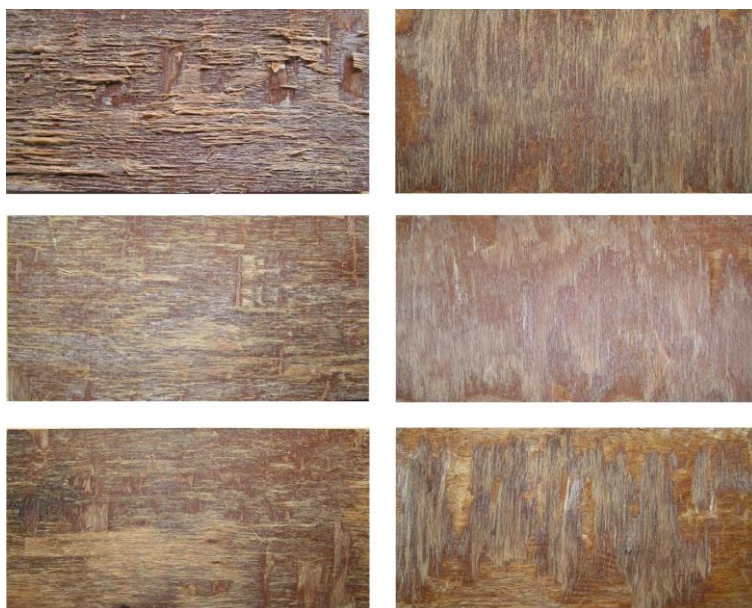
Слика 240. Изглед на површините на фурнирите по одлепувањето [136]
