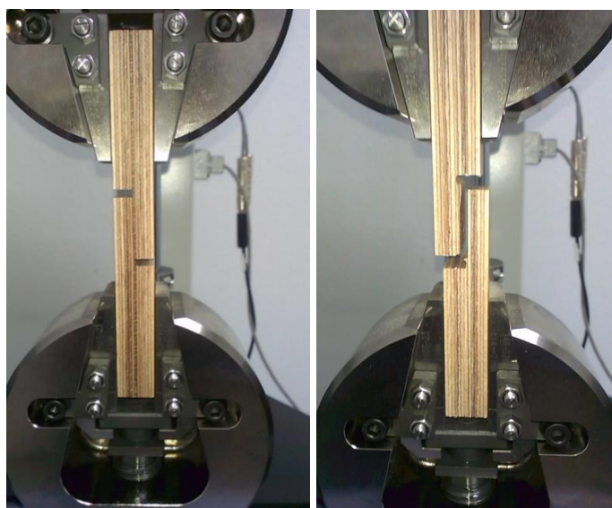
Слика 236. Испитување на јакоста на смолкнување на фурнирски плочи [137]
