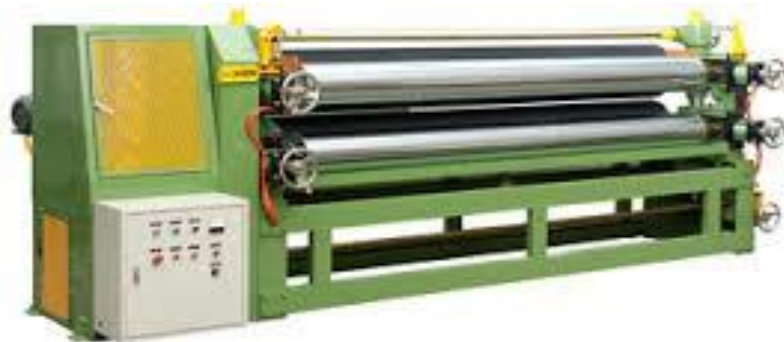
Слика 201. Машина за контактено нанесување на лепило [30]
