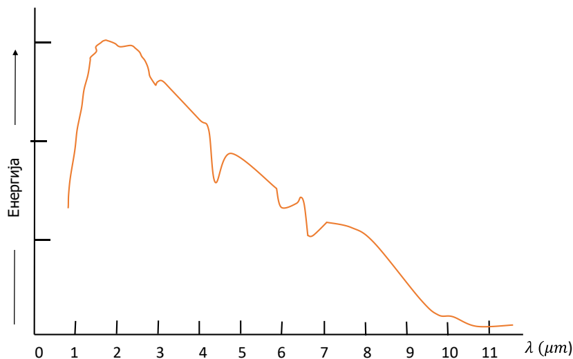
Слика 6.5 Спектрална дистрибуција на енергијата добиена од Нернстов извор при температура од околу 2200K
