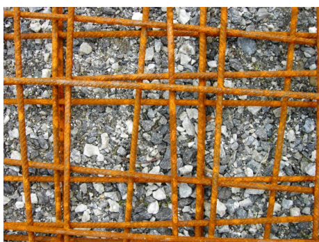
Сл. 5.4. Корозијата на железото е резултат на редокс реакциите што се одвиваат на неговата површина.
